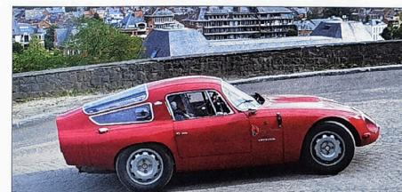
► Parmi les voitures exceptionnelles, cette Alfa Romeo TZ 1 de 1964 : châssis tubulaire, carrosserie surbaissée, roues arrière indépendantes, moteur 1,6 l à double arbre à cames en tête généralement porté à 150 ch..
